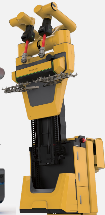
配网带电作业机器人
