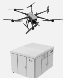
大型换电机场
