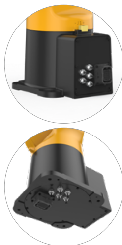
两种出线方式 Two connection outlets
