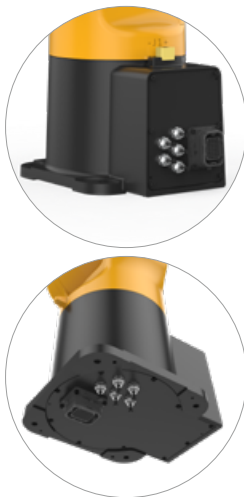
两种出线方式 Two connection outlets
